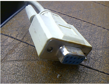
Abb.10: Ein von der normalen Luftfeuchtigkeit in einem Fahrzeug angeammelter RS-232-Stecker
